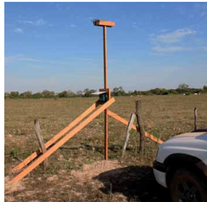
Messstation zur automatischen Lauterfassung
